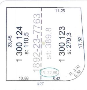
Dans cet exemple, la mesure de front est la somme des deux mesures de lignes de lot et de la moitiée de la mesure de l'arc de cercle
