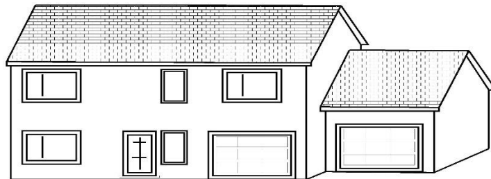
Garage intégré et attenant
